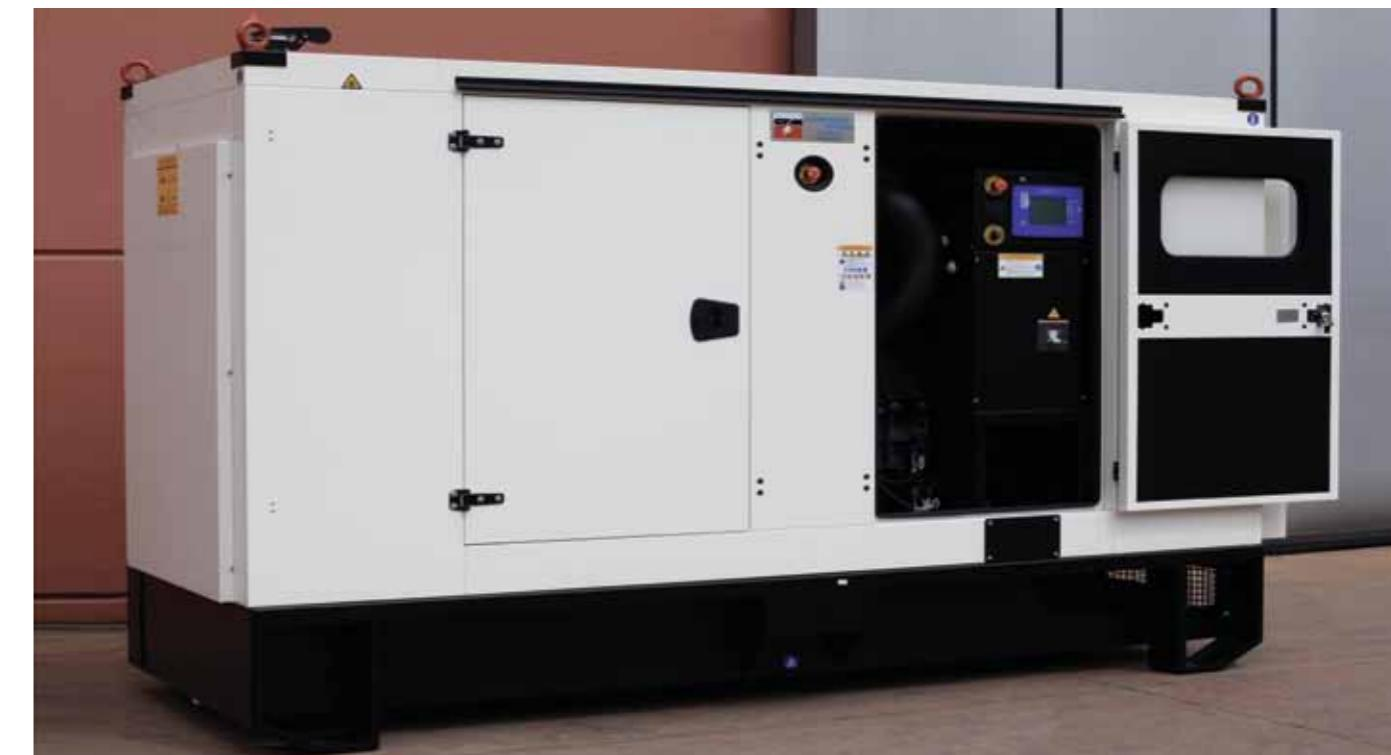
La versione insonorizzata è concepita di tipo autoportante con struttura in lamiera di acciaio presso piegata zincata a caldo, con 4 punti di sollevamento e sistema di espulsione gas di scarico installato all'interno con adeguate protezioni contro i contatti accidentali. L'accessibilità è garantita da ampie porte laterali e pannelli rimovibili. Ogni componente della cofanatura è sottoposto a verniciatura a polveri prima di essere assemblato.
